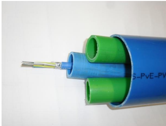
Figuur 5.14: Voorbeeld van een type mantelbuis met daarin weer een aantal mantelbuizen (hdpe-buizen), waarvan één met een telecomkabel. Het model maakt verwijzingen tussen mantelbuizen en kabels mogelijk.
